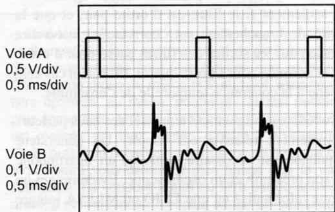
Figure 200 - En faisant varier la fréquence du signal rectangulaire, on constate que les pics de réponse des haut-parleurs médium et aigu restent en correspondance temporelle. C'est le cas si les variations de phase de ces deux voies se produisent à la même vitesse par rapport à la fréquence. Si l'une des voies présente une variation de phase plus rapide, les pics se décalent petit à petit lorsque la fréquence augmente. Les filtres symétriques et complémentaires produisent des variations de phase de même amplitude et de même vitesse sur les sorties passe-bas et passe-haut, et par conséquent le calage temporel obtenu est correct à toute fréquence.
