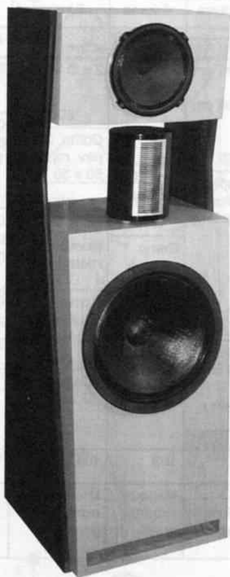
Figure 176 - Associé au 38 cm Davis 40RCA15 et au Supravox T215 en bas-médium, le tweeter à ruban Raven R3 avec ses 30 kg d'aimants offre une sensibilité de 100 dB et une possibilité de coupure aussi basse que 500 Hz ! L'avantage d'une membrane légère dès le registre bas-médium est évident, mais pour un tweeter à près de 2 000 Euros pièce, j'avoue hésiter... D'autant que ses petits frères R1, R2 et R2.5 sont excellents eux aussi. (documentation H-P Systèmes)
