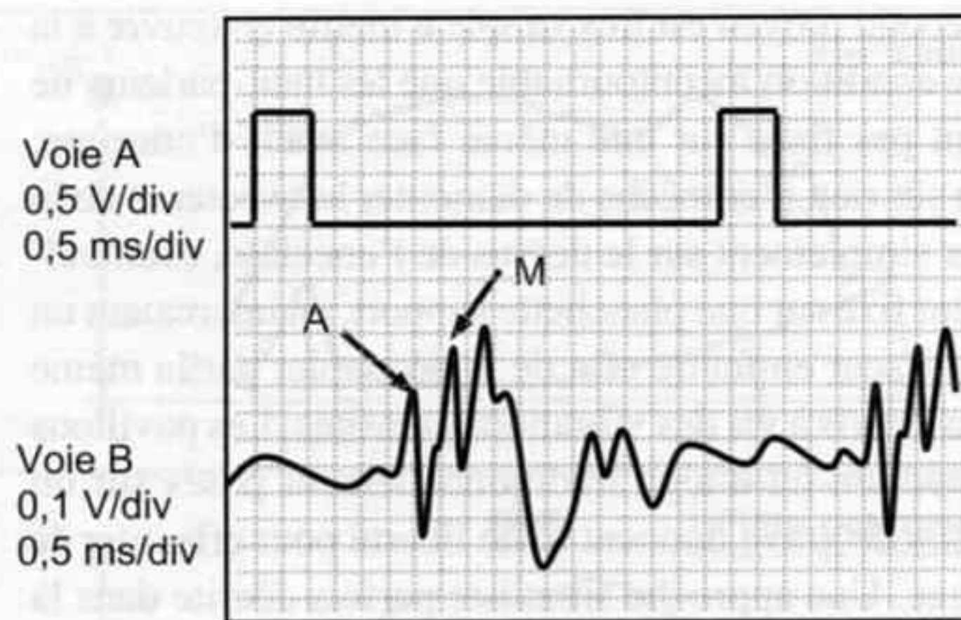
Figure 198 - Le tweeter a été ajouté et un nouveau pic apparaît en A. Sa polarité est dans le sens normal mais son retard de 3 ms seulement. Le tweeter est donc en avance de 0,5 ms sur le médium. Le front descendant de la réponse du tweeter se superpose au front montant du médium en M. Ce décalage de 0,5 ms correspond à un déphasage d'une période entière soit 2\pi , à la fréquence de raccordement du filtre d'ordre 4, de 2 kHz. En déplaçant le tweeter vers l'arrière, on voit avancer sa trace vers la droite. Lorsqu'elle se superpose à celle du médium, le calage temporel est correct à la fréquence du signal. Il peut ne pas l'être à d'autres fréquences...
